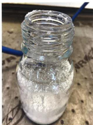
Figur 1: Bild av glasburk med polymeriserad HFO1234yf (?). Skummet bildades när en slang från en köldmedieflaska med R513A riktades ner i burken och flaskan öppnades kort från vätskesidan.
