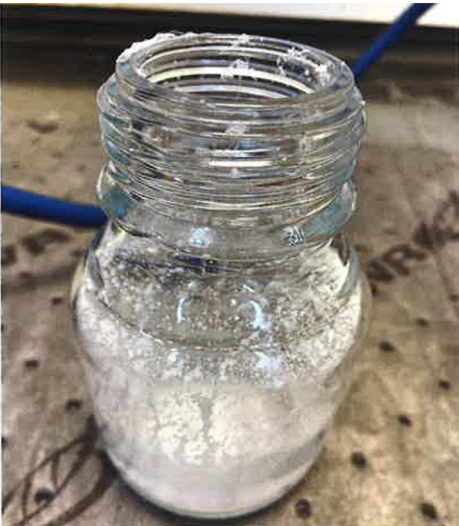
Figur 1: Bild av glasburk med polymeriserad HFO1234yf (?). Skummet bildades när en slang från en köldmedieflaska med R513A riktades ner i burken och flaskan öppnades kort från vätskesidan.
